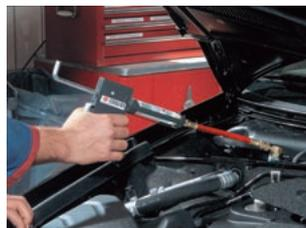
3. Iniettare l'intero contenuto nel circuito. Fare circolare il veicolo per strada con il climatizzatore in funzione per un'ora e successivamente controllare.
