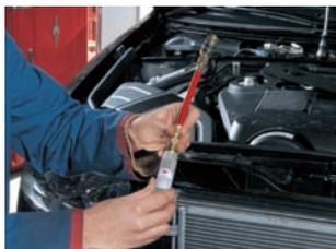
1. Dopo aver utilizzato l'additivo tracciante e ripristinato il refrigerante nell'impianto, inserire il turafalle Art. 0892 764 500 con l'apposito tubo di collegamento
